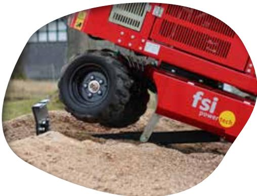
**Hydraulisch verstellbares Planierschild**
