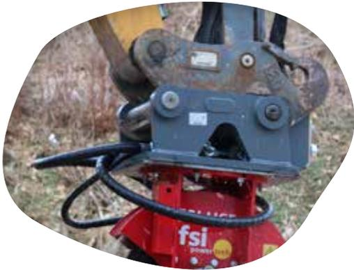
**Schnellwechsel-Anbauadapter für Bagger**
