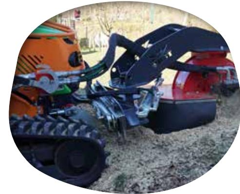
**Schnellwechsel-Anbauadapter für funkgesteuerte Raupenfahrzeuge**
