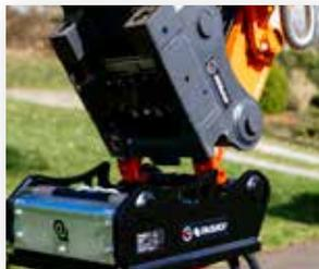
Schnellwechsel-Anbauadapter für Bagger
