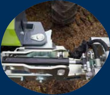
45° hydr. Anfahrssicherung mit Werkzeugvordruck
