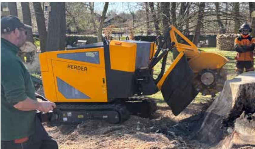
men das Fräsmaterial aus dem Schnitt. Ein Gummi-Stofftuch am Fräsrاد sorgt dafür, dass das Material nicht zu sehr durch die Gegend spritzt.
