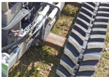
Das Fahrwerk ist teleskopierbar. Dadurch ist die Raupe sehr standsicher.
