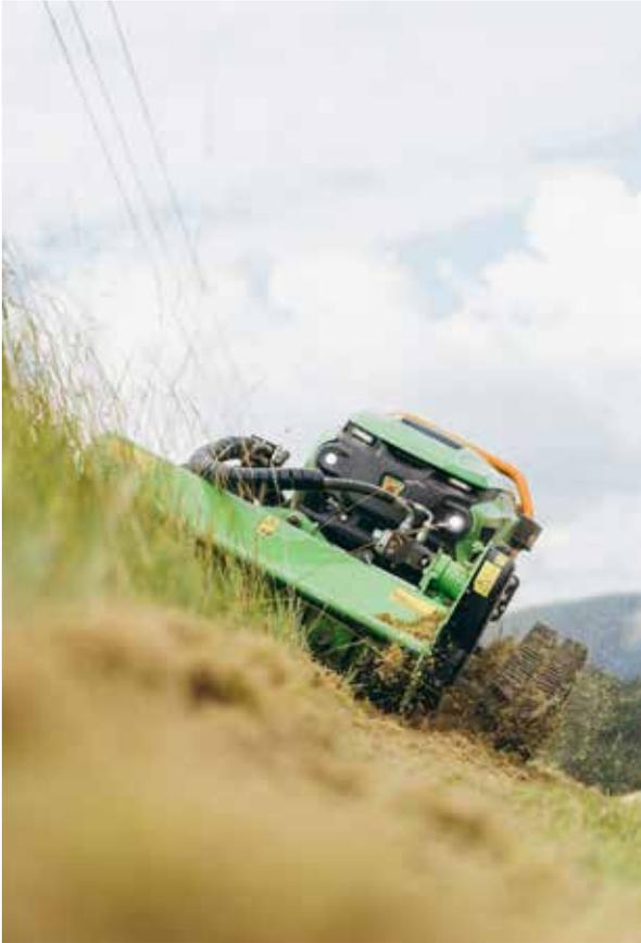
ist für harte Beanspruchungen konzipiert. Dank doppelter Kettenführung über Parallel-Leiträder und zentraler Führungskufe bleibt die Kette immer in der Spur. Für professionelle Einsätze im Forst empfiehlt VOGT darüber hinaus das Forstschutzpaket mit einem zusätzlichen, massiven Schutzrahmen für die komplette Maschine.
