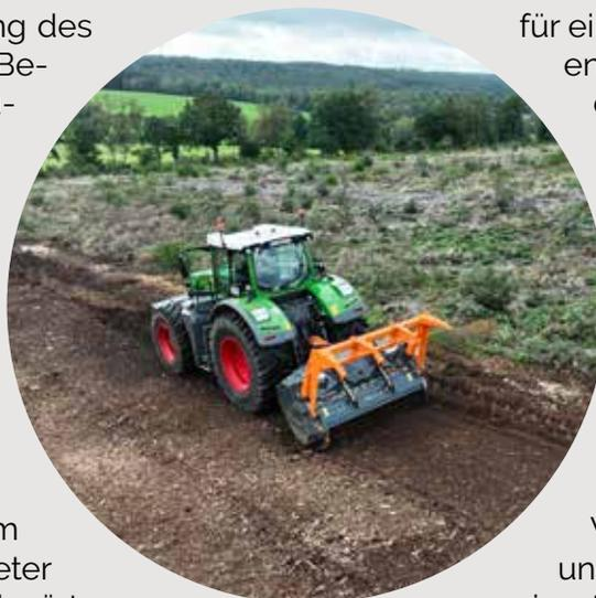
Rotordurchmesser des TMC Mulchers sorgt für eine große Schwungmasse und damit hohe Schlagkraft in massivem Holzmaterial. Nachdem die Bahn vorgearbeitet und der Forstmulcher die größten Hindernisse zerkleinert hat, wird die Bahn bei geschlossener Heckklappe nochmals im Vorwärtsgang abgefahren, um auch die verbliebenen Holzreste zu zerkleinern und die Fläche gerade zu ziehen.
