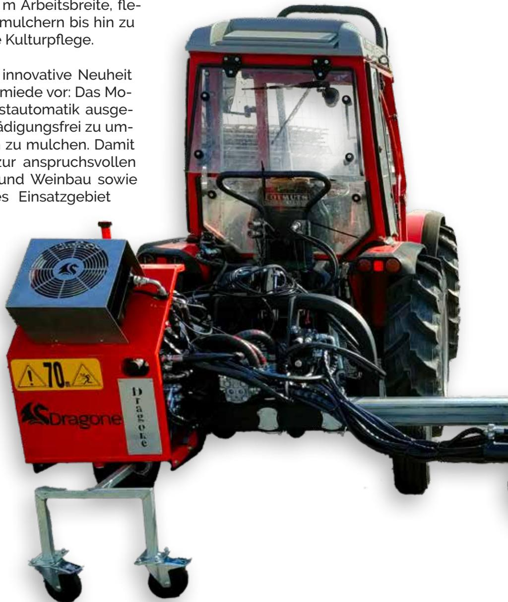
Mulcher flexibel an die Reihenbreite und das jeweilige Einsatzgebiet angepasst werden, darüber hinaus kann der Materialeinlass durch die Gehäusewinkelverstellung justiert werden. Gesteuert werden die einzelnen Hydraulikfunktionen mittels elektrisch-proportionalem Joystick aus der Schlepperkabine.
