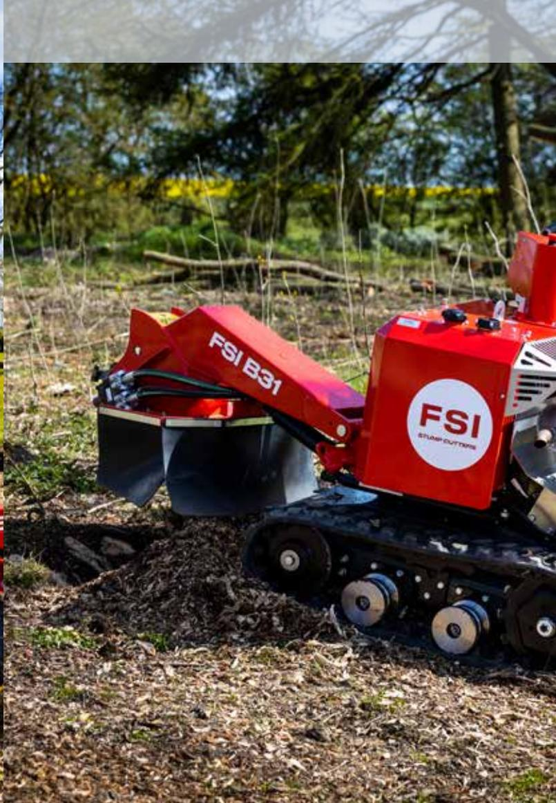
lische Antriebskonzept konnten wir eine sehr kompakte Maschine bauen, die sich durch eine einfache Bedienung und flexible Einsatzmöglichkeiten auszeichnet.“ Ein Nachspannen oder Austausch der Keilriemen ist nicht mehr nötig, wodurch sich der Wartungsaufwand und die Betriebskosten auf ein Minimum reduzieren. Das Soft-Start-Ventil schont zusätzlich den Antriebsstrang, bei hohen Temperaturen sorgt der integrierte Ölkühler für einen zuverlässigen Betrieb.
