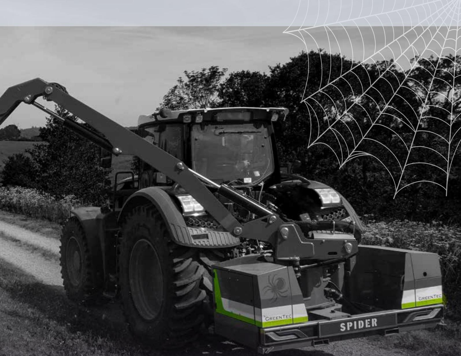
den Systemen gewechselt werden. Des Weiteren sorgt die hydraulische Auflagedruckentlastung (AUTO HEIGHT CONTROL) für eine automatische Boden Anpassung des Mulchkopfes. Für alle SPIDER Modelle verwendet GREENTEC den hochfesten STRENX S700 Stahl, der 50% mehr Zug- und Streckfestigkeit gegenüber herkömmlichem Konstruktionsstahl verspricht. Zusätzlich sind die Auslegearme innenliegend verstärkt, sodass die Maschine auch bei extremen Belastungen robust und verwindungssteif bleibt.
