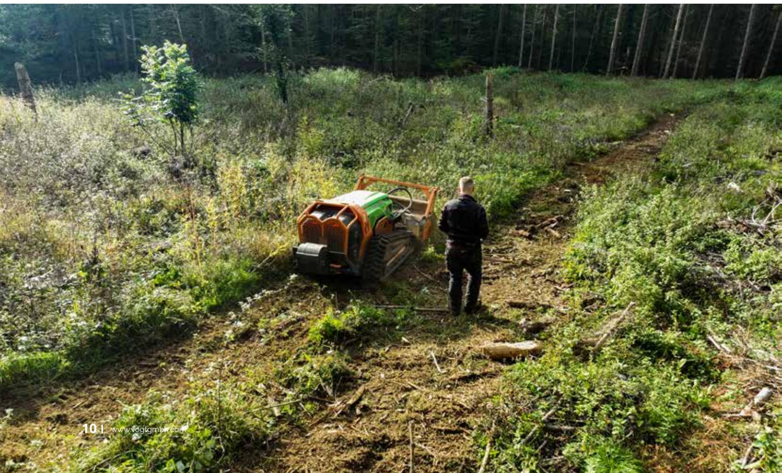
mit lässt sich Holzmaterial bis ca. 300 mm Durchmesser sauber zerkleinern, mit Hilfe der hydraulisch verstellbaren Frontklappe wird auch stehendes Gehölz und sperriges Material problemlos verarbeitet. Zusätzlich zum Forstmulcher besitzt Meyer eine professionelle RITTER-Winde als Anbaugerät für die LV 600. Die Winde dient zum einen als Fällhilfe in unzugänglichen Bereichen und zum anderen als Vorrückwinde, also zum Vorliefern von Holz aus größerer Entfernung zur Rückegasse.
